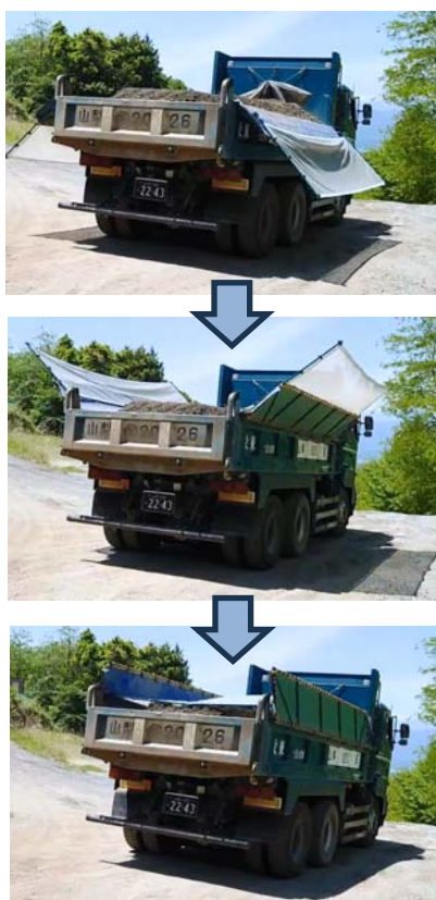
シート開閉動作写真(当社ダンプ)
