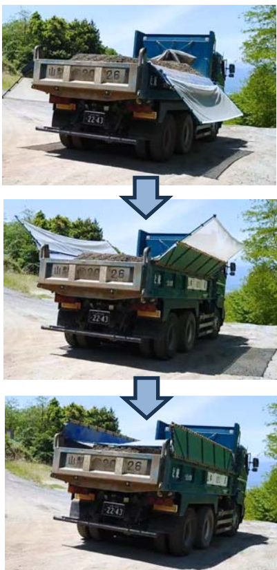
シート開閉動作写真(当社ダンプ)
