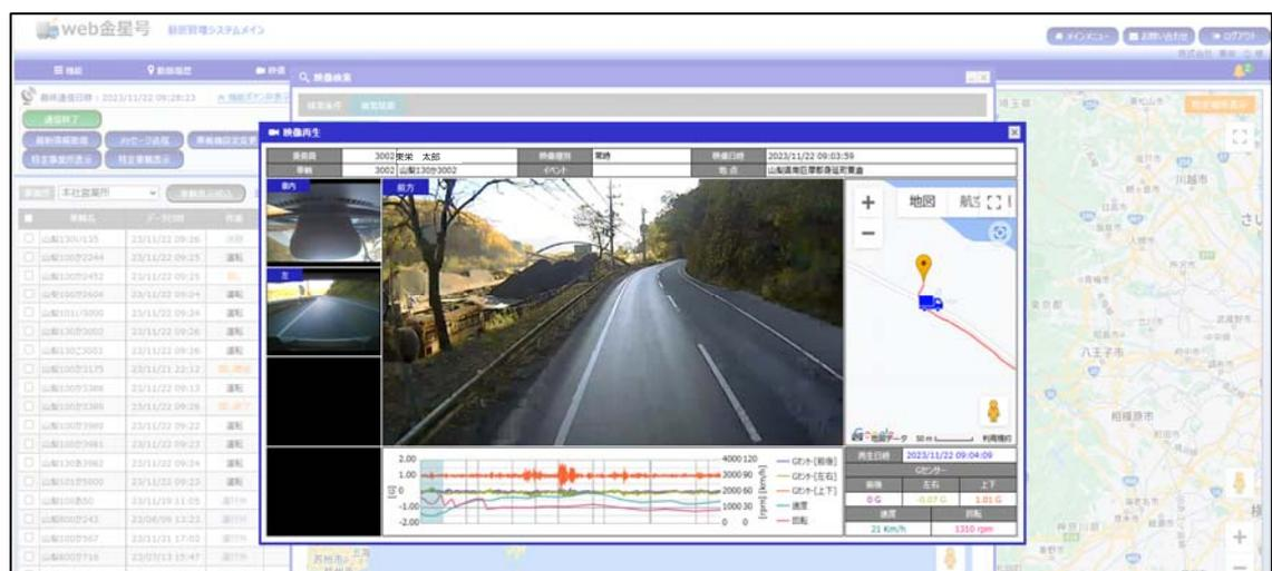
デジタコはドラレコと連動しており、事務所の車両部パソコンにて各車両のリアルタイムの動向及びドラレコ動画を確認することができ、また、ドラレコは前方および後方に装備しています急ブレーキ等のメールが入った際、その時の状況をクラウドにて管理しています
